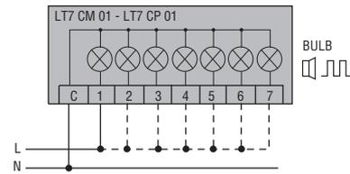
Соедините клеммы C и 1 как показано на схеме для подключения первого модуля.
