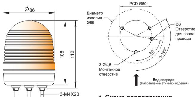
▲ Схема расположения отверстий для шпилек
