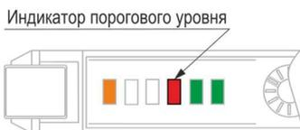
Рисунок 11 – Индикатор порогового уровня срабатывания усилителя
