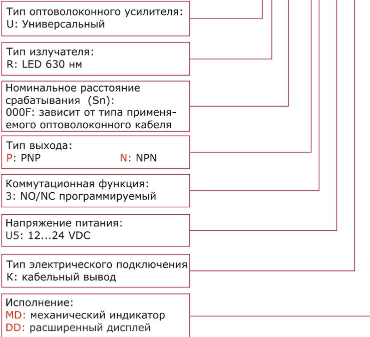
*Рисунок 1 – Структура условного обозначения оптоволоконных усилителей*
